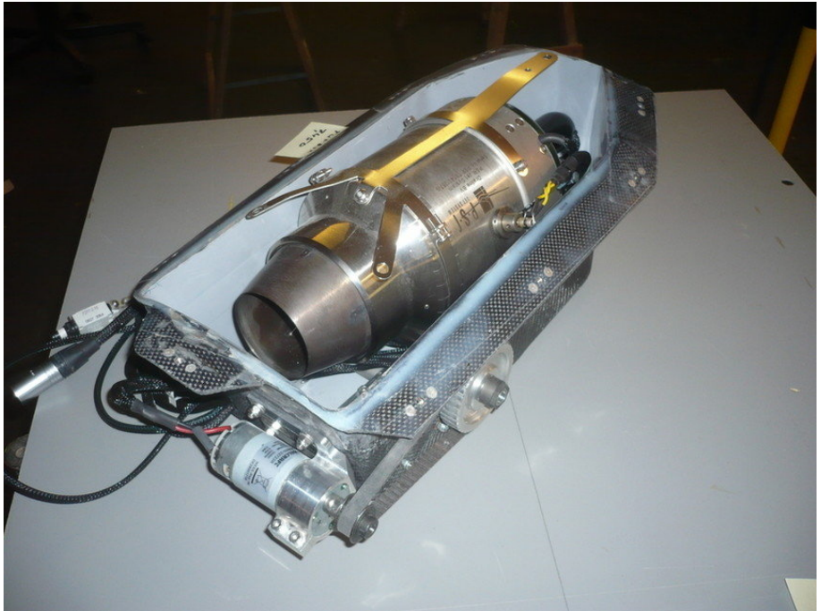
Triebwerkskasten mit Triebwerk und Ausfahrmechanik
