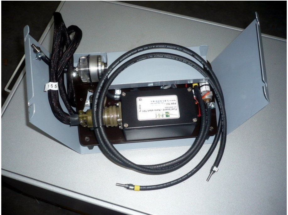
Kraftstoffmodul mit Pumpe, Ventilen, Filter und Durchflussmessung
